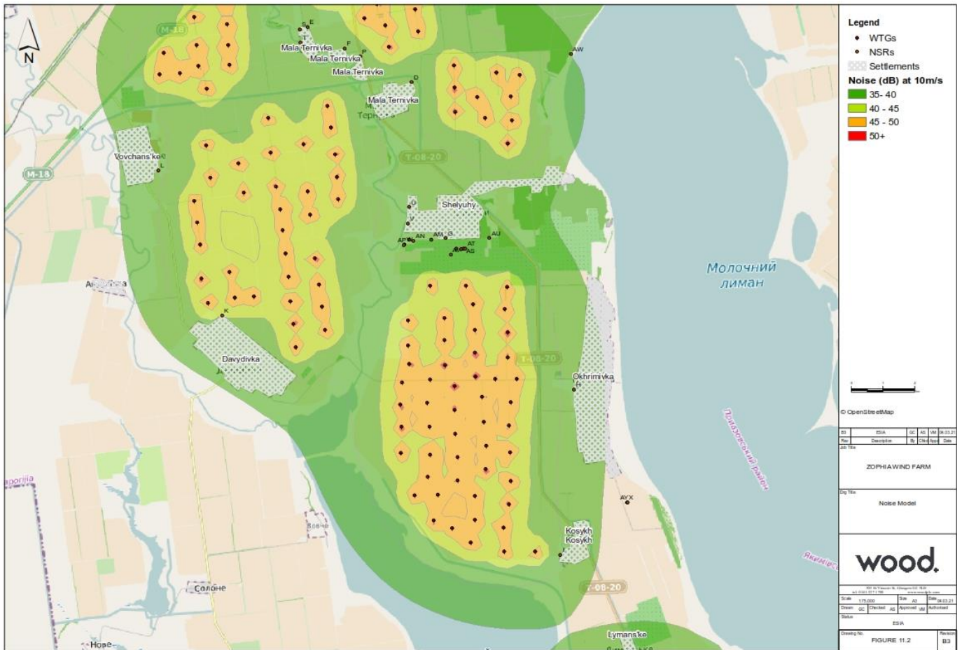
Рисунок 10-2. Моделювання шуму (центральна частина вітрополя)
